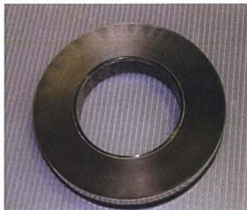
図 7-11 ファインメットコアの外観写真 (日立金属, FT-3H, 外径 155 mm, 内径 89 mm)
