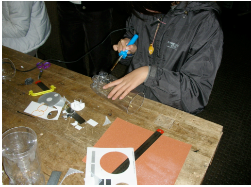
a) ホットカッターを使った切断作業
