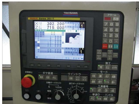
電腦旋盤の全体と操作パネル
