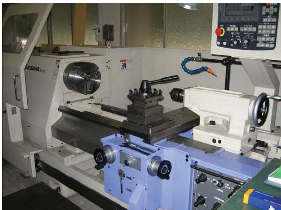
電腦旋盤の全体と操作パネル
