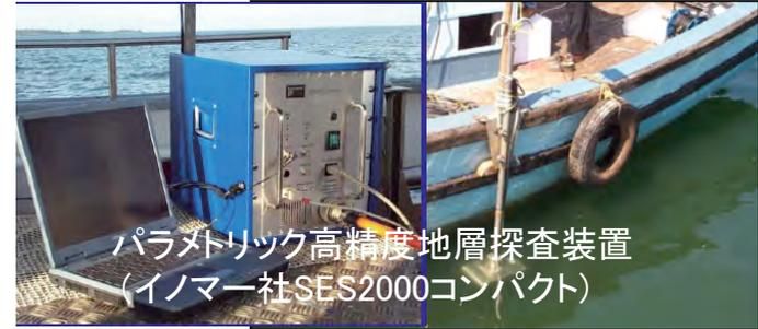
パラメトリック高精度地層探査装置
