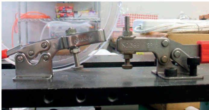
図 3 左がピンの曲がったクランプ、右が固定時水平の正常クランプ
