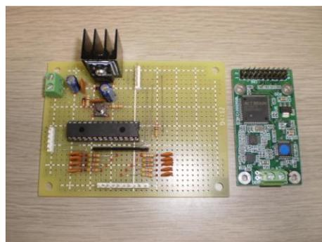
図1 初号機の制御用ボード
