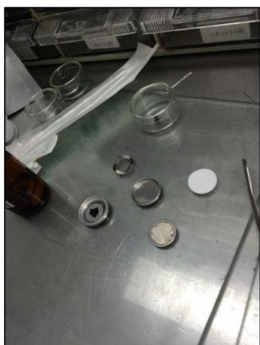
図4 コインセル構成部材
