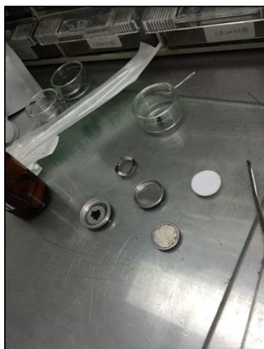
図4 コインセル構成部材
