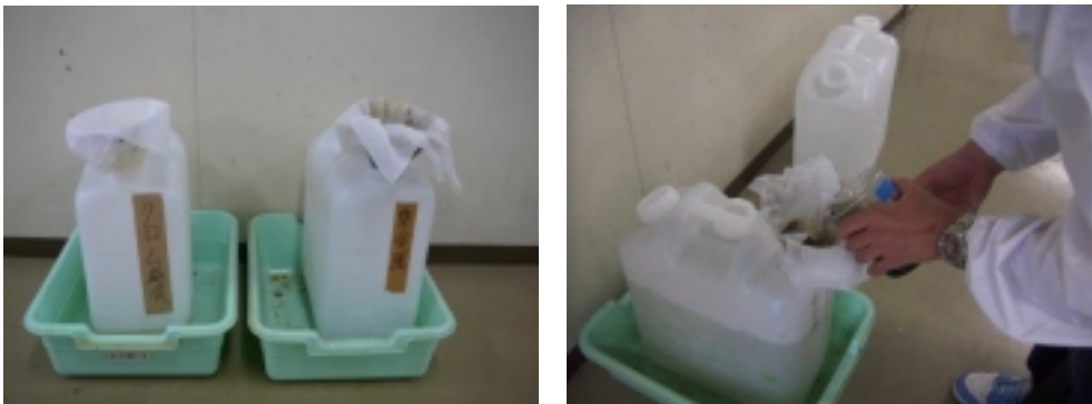
図 1 廃液タンク及び排出状況(定性分析実験ではクロム廃液と重金属廃液とに分別している)
