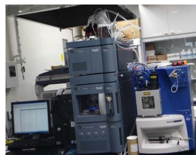
図 1：沖縄高等専門学校の LC/ESI-Q-MS MS は Waters 社製 Quatro micro LC は Waters 社製 AcQuity
