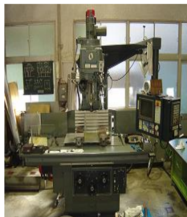
牧野フライス製作所製NCフライス盤
