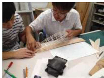
図 3. 模型躯体にハル材をあてがう. カヌー製作で最も難儀な工程
