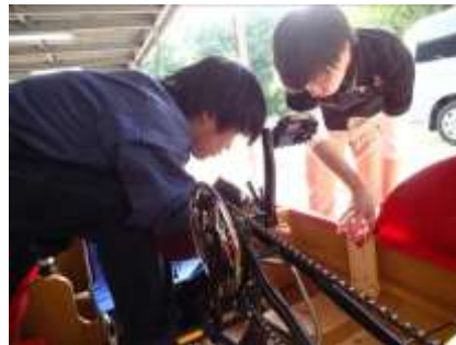
h) フェンダーの取り付け
