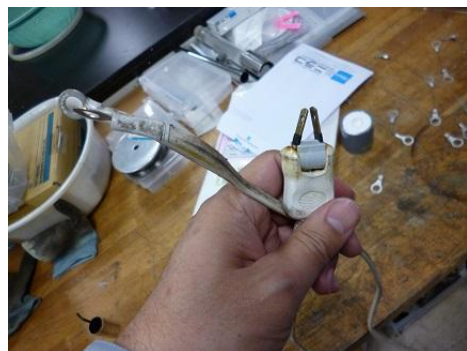
図3. 変形した電気プラグ
