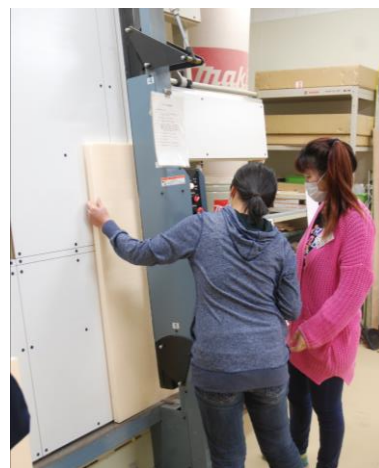
図 2 パネルソーの使用
