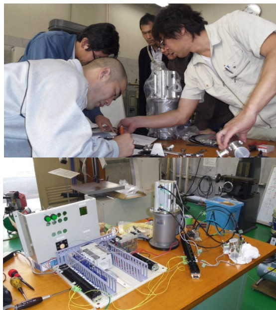
図 4. 三方弁/メインバルブ動作確認
