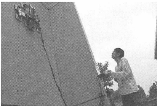
図 3 高構造物検査のための壁面移動装置
