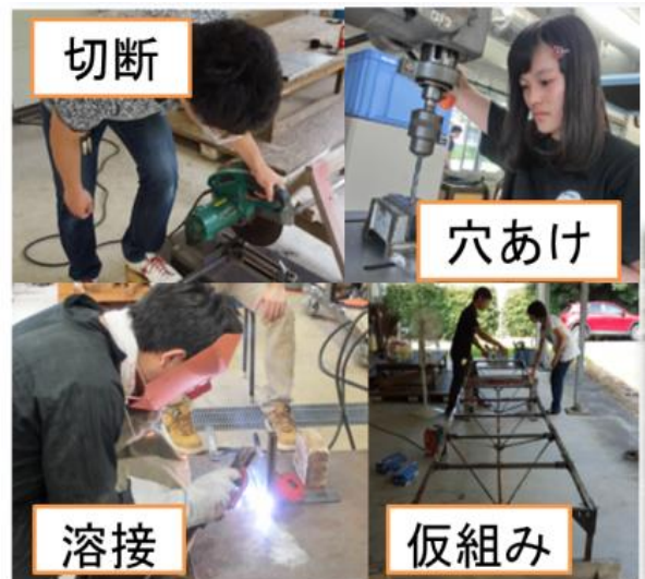
図-2 部材加工の作業風景
