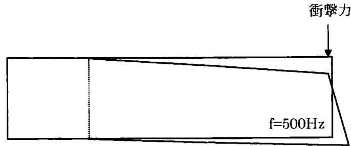
図 5-7 BEM 解析による 500Hz の衝撃力作用時の変形モード
