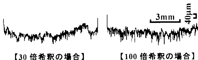
図 2.16 研削油剤希釈倍率が砥石作業面形状に及ぼす影響
