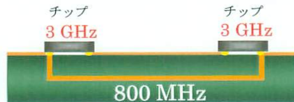
図 1.2 プリント基板におけるチップ-チップ間配線高速化の必要性
