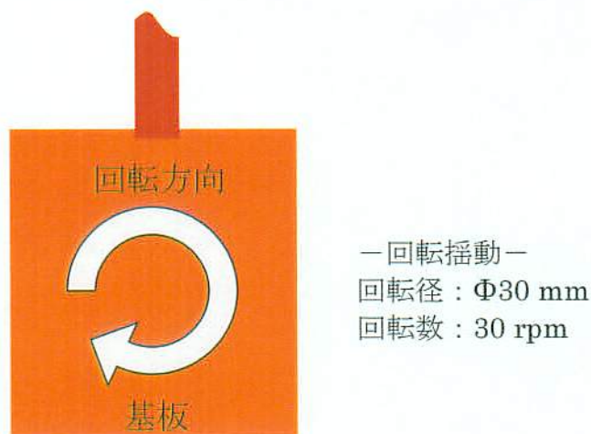
図 2.20 試料基板の回転揺動条件
