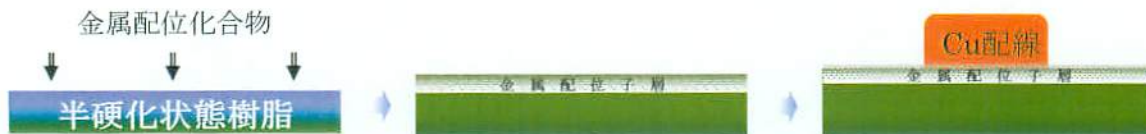
図1.5 アンカーフリーCu配線形成工程
