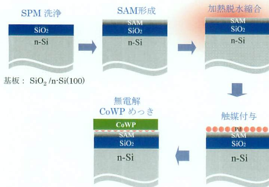
図 3.4 SiO 2 基板への無電解めっき薄膜形成基本プロセスフロー
