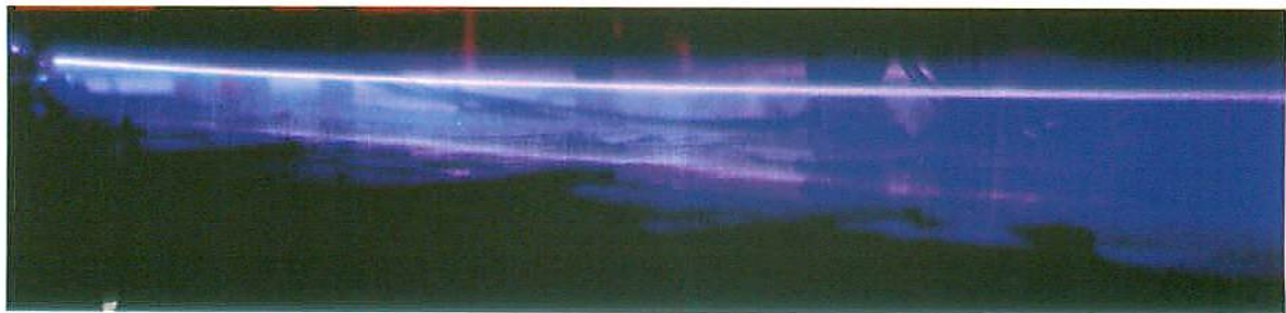
(c) 軸方向への撮影（線対平板型電極、10ショット、5 m 全体）
