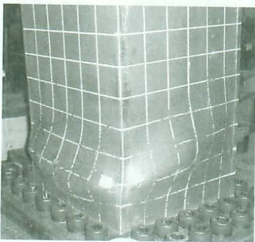
写真 5-2 LN-57 崩壊状況(南西側)
