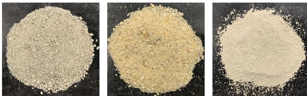
写真 6-1 BFS、天然珪砂および LSP の外観（左：BFS，中央：天然珪砂，右：LSP）
