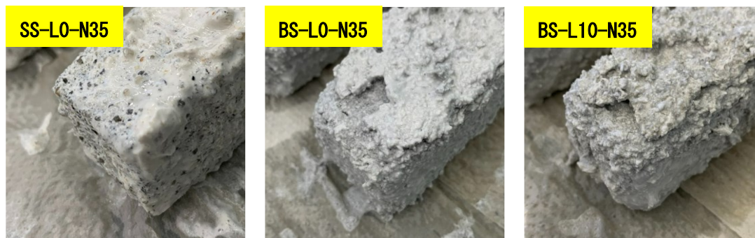
写真 6-7 硫酸浸漬期間における各種モルタルの表面（W/C=35%，硫酸浸漬 35 日）
