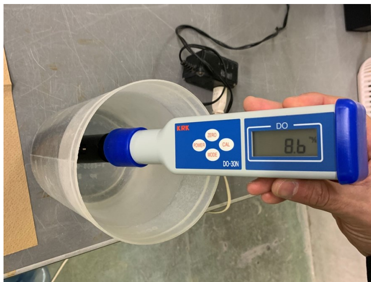
写真 4-3 通水試験に用いた供給水の DO 測定
