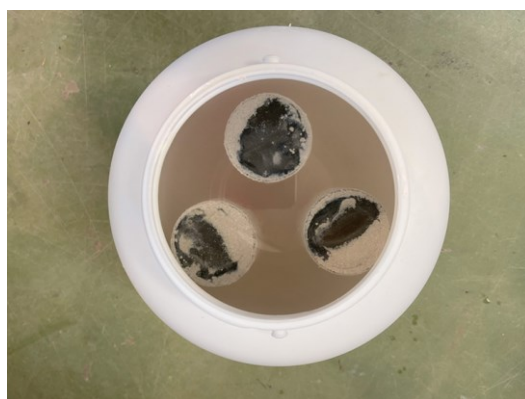
写真 5-5 硫酸浸漬試験の試験容器と供試体（水準 2 の場合）
