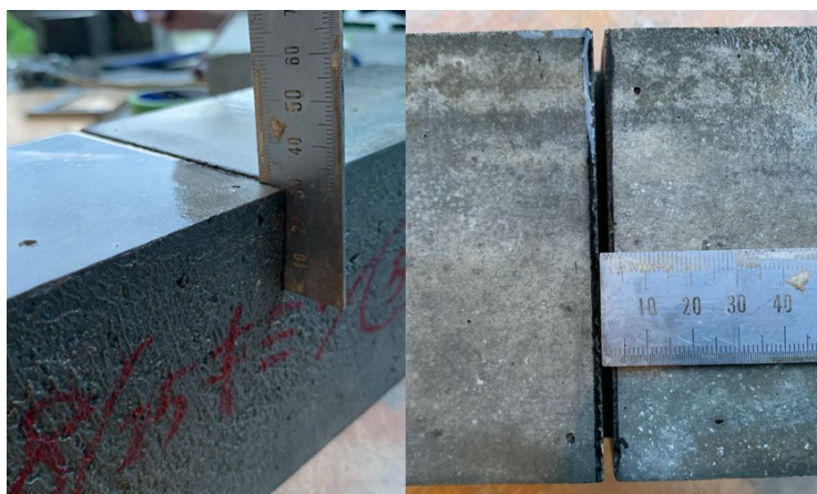
写真 2-1 供試体に導入した切欠き
