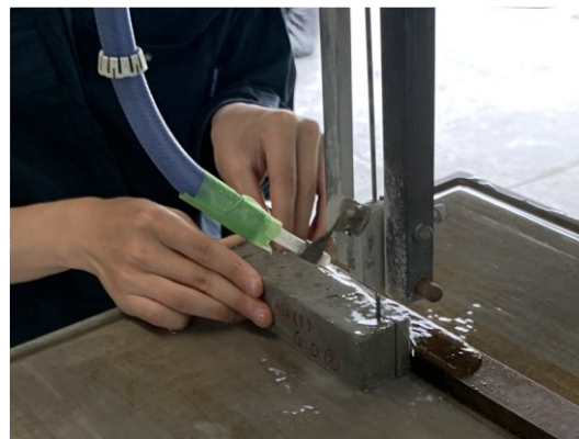
写真 5-2 試験片の切断
