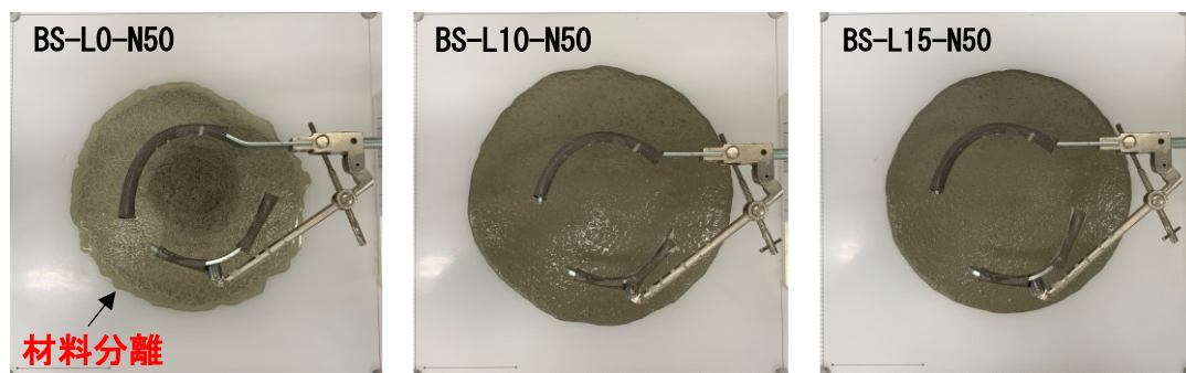
写真 6-4 W/C=50%における CEM I を用いた BFS モルタルの外観 (左 : LSP=0%, 中央 : LSP=10%, 右 : LSP=15%)
