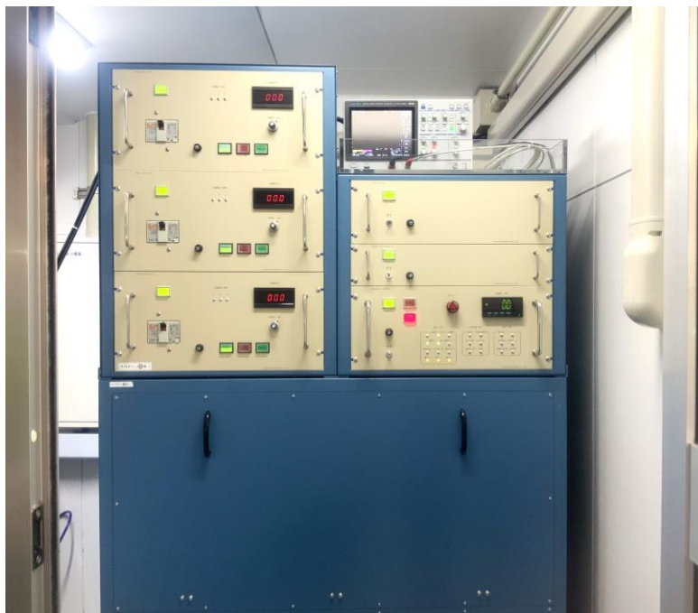
図 6-5 アニサキス殺虫装置プロトタイプ機のパルス電源
