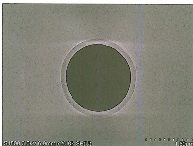
図 2-9 肉薄ガラス管を材料としたナノピペット先端の SEM 像(ヒータ電力 15.5W)
