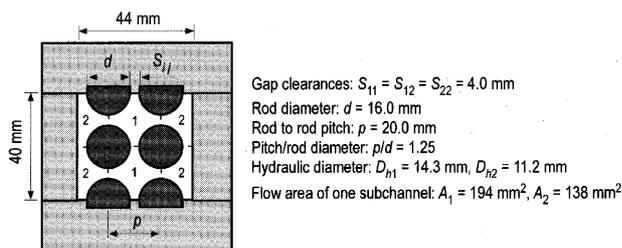
Fig. 13 Cross-section of Sadatomi et al.'s  $2 \times 3$  rod channel<sup>(21)</sup>
