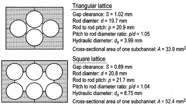
Fig. 10 Cross-sections of Rudzinski et al.'s test sections<sup>(22)</sup>
