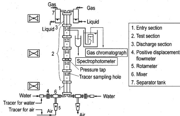
Fig. 2 Test apparatus
