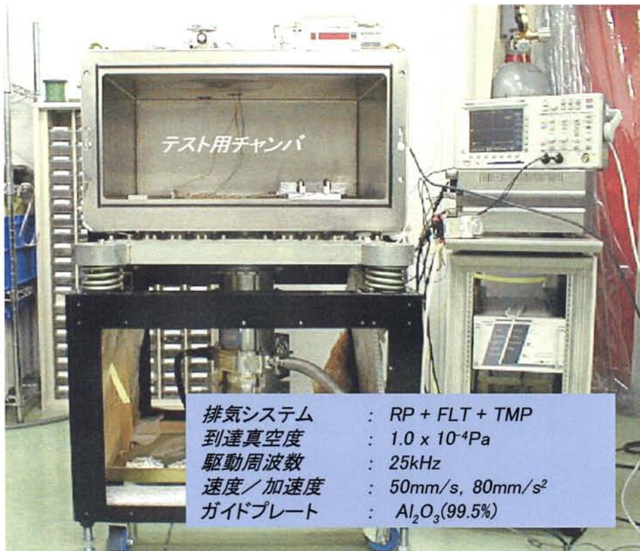
図 5.15 真空内耐久性試験に使用した真空チャンバー外観
