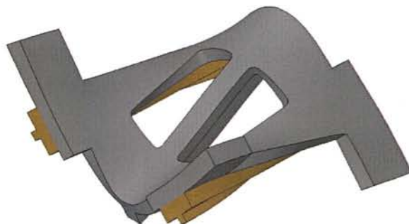
図 3.10 ムク構造上段ステージの3次振動モード (1897Hz)
