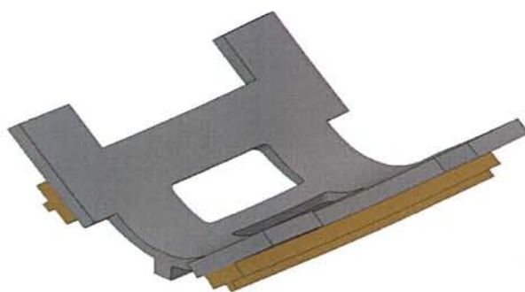
図 3.9 ムク構造上段ステージの 2 次振動モード (864Hz)
