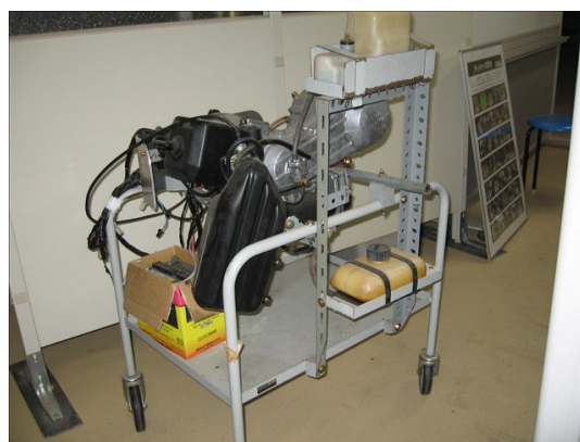
写真1 キットカーエンジンの単独運転教材製作品（左：正面、右：後面）
