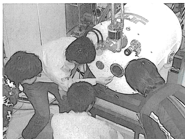
図1 10テスラヘリウムフリー超伝導磁石のボア内に単層カーボンナノチューブ分散ゼラチンゾル試料を挿入している様子
