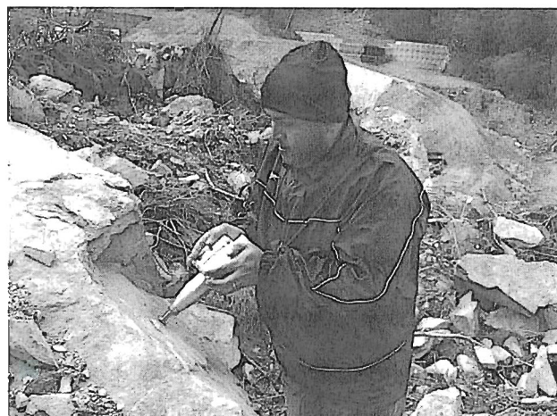
写真4 土石流の末端における岩塊のP波（縦波）伝播速度の測定
