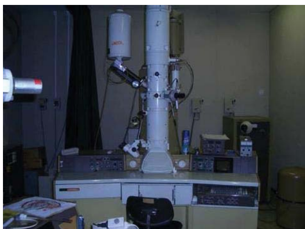
図1 透過型電子顕微鏡 (JEM-2000FX) の概観
