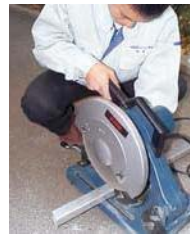
図3 アルミ材の切断
