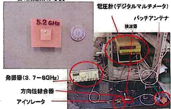
図2：FR-4基板上に作成した小型パッチアンテナとその測定の様子。
