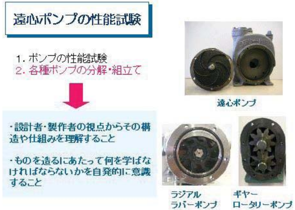
図6 改善事例（「遠心ポンプの性能試験」，担当：吉川，宗像）
