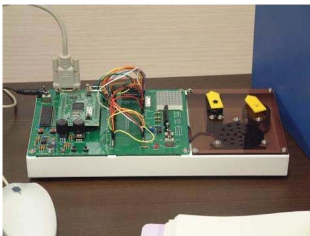
Fig. 5. マイコンを用いた組込みシステム実習教材
