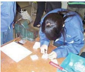
図1 発泡スチロールを切り、フルモールド型とする
