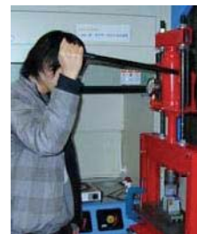
図9 プレス機による曲げ試験
