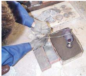
図2 型を鋳物砂に溶解したアルミを鋳造する。
