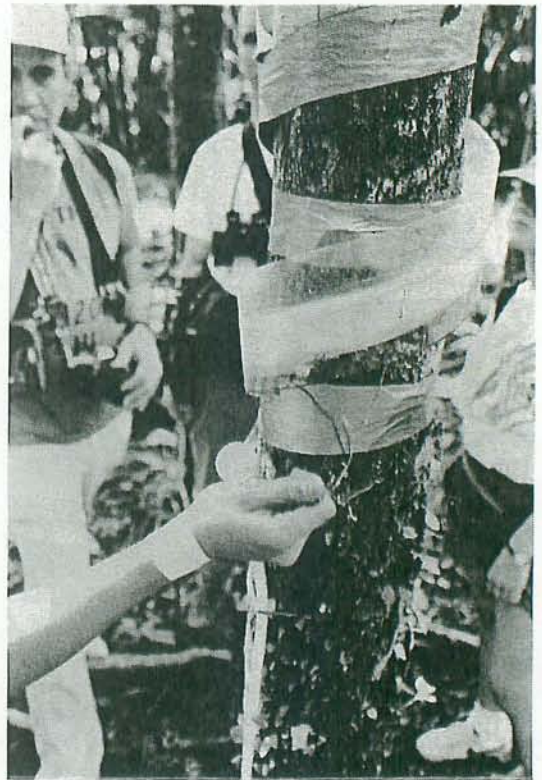
写真4. 樹表面を伝う降水の量を測定する装置
