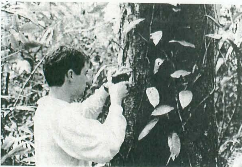
写真8. プローブ（検知端子）を対象木に接続する植物生理学者
