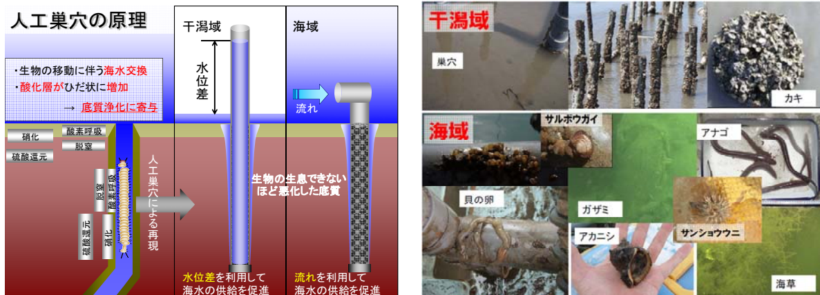
図-2 人工巣穴の原理(左)と人工巣穴に付着した生物(右)
