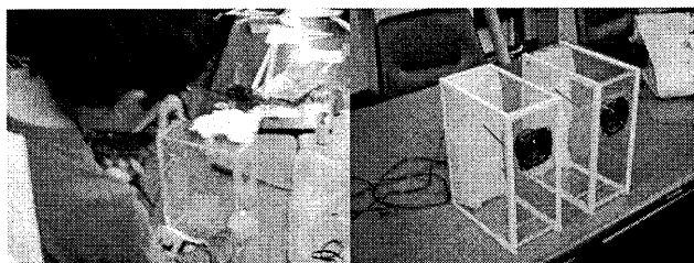
図4 アクリル板を使ったエンクロージャの作製
