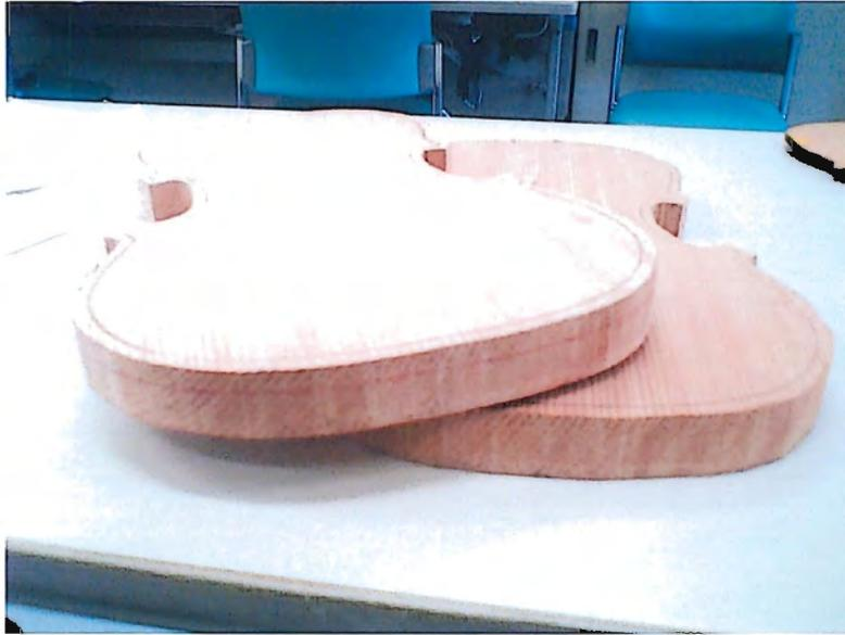
図4.4.10 外形を切出したスギ板
