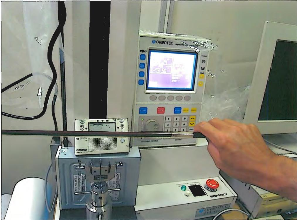
図 5. 2. 6 バイオリン弦の調律時の張力測定
