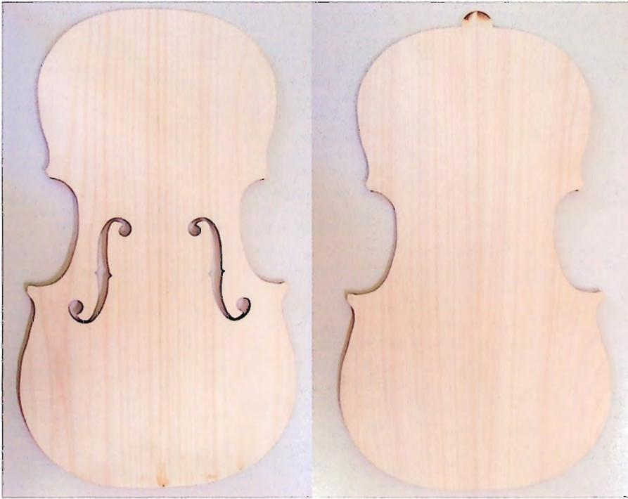
図4.4.3 レーザー加工機で切断した表と裏板(ヒノキ)
