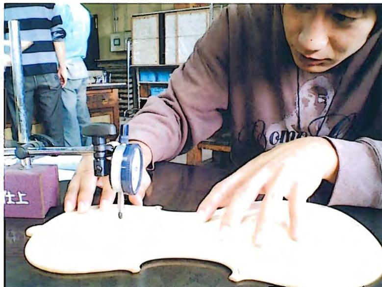
図4.4.11 バイオリン表板からの寸法採取
