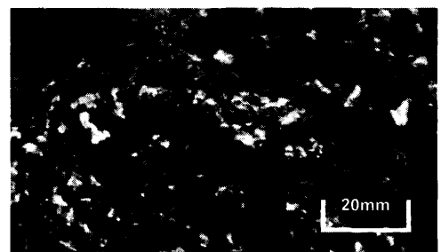
写真3 供試体破断面の様相の一例 (集束タイプ, W/B=33%, V_f=3.0\% ) - 実験3-
