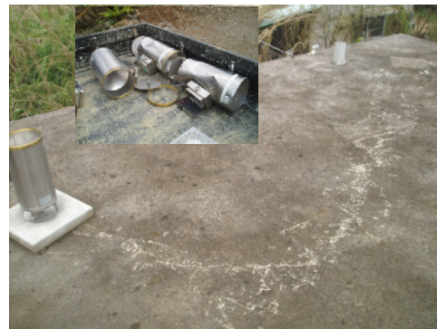
図2：T0613のJIRCASにおける10分降水量、風速、風向の変化（上）。台風により破壊された雨量計とその軌跡（下）。
