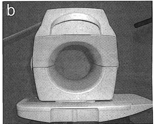
Fig. 1 Headコイル(a)と短径コイル(b) Headコイルの内径(縦×横); 245×235(mm), 短径コイルの内径(縦×横); 150×145(mm)
