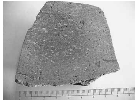
写真1 加久藤火砕流堆積物の研磨写真
