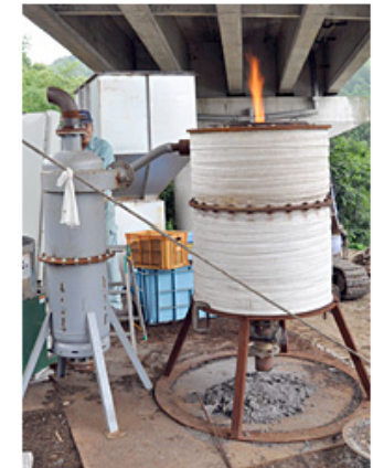
畜産堆肥を原料とする新型炉（右）の燃焼試験＝出水市上鯖瀬の明豊エコ・テクノ
