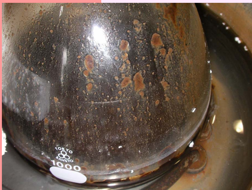
減圧乾燥中の容器内部 (鶏糞メタン発酵残さ+廃グリセリン)
