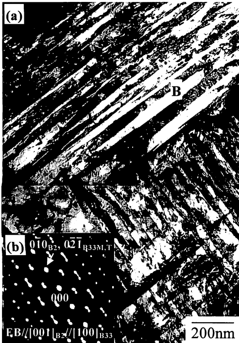
図4 (a) Zr_{50}Co_{39}Ni_{11} 合金の破断部近傍の明視野像. (b) (a) の領域 B からの電子回折図形.
