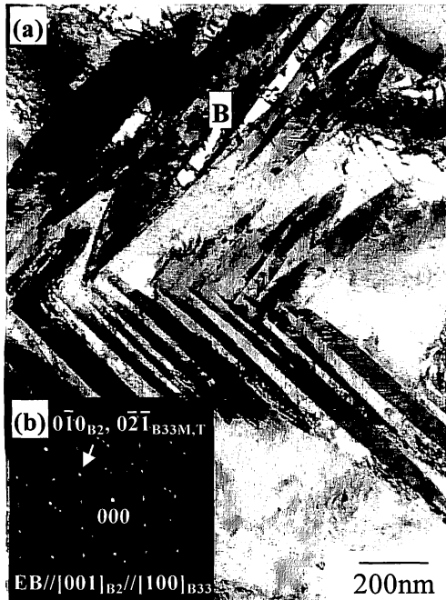
図8 (a) Zr_{50}Co_{40}Pd_{10} 合金の破断部近傍の明視野像。(b) (a)の領域Bからの電子回折図形。
