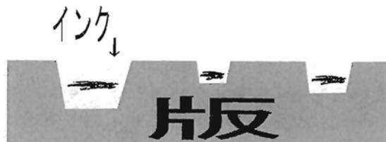
(図3) 凹版画 構造断面図
