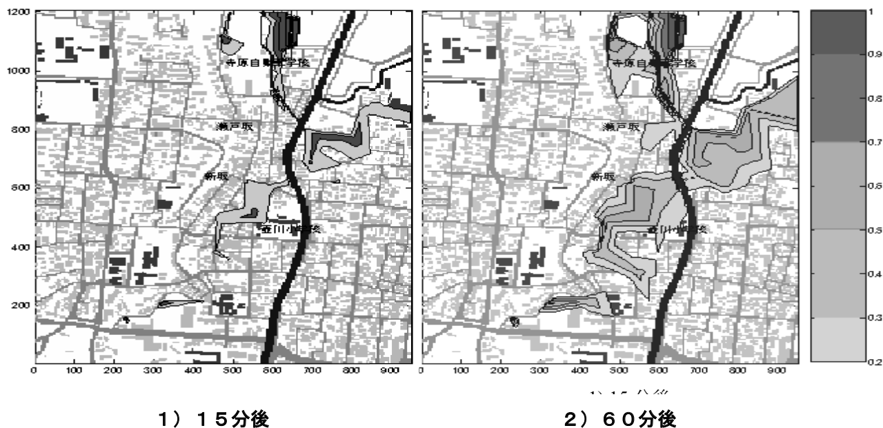
図 3. 6 レベル堪水法による内水氾濫の再現結果（降雨強度 80mm）
