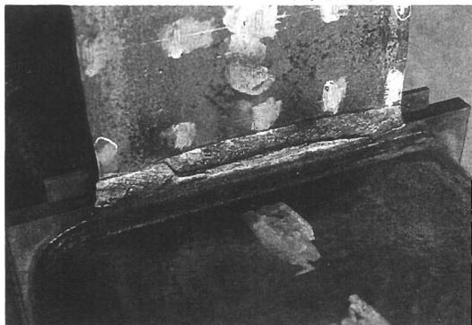
写真 6.5.6 下フランジの破断(BS-4)
