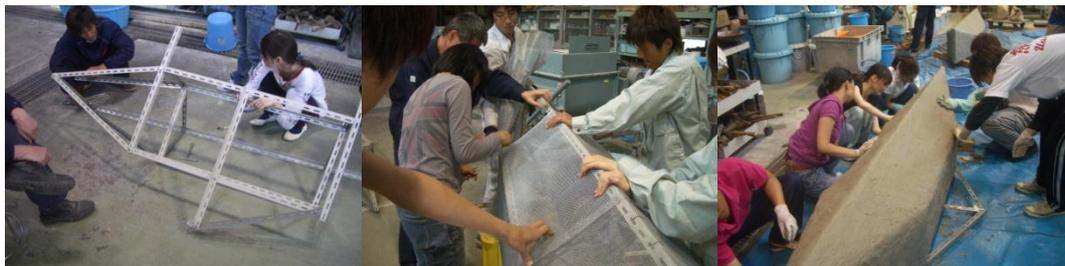
フレームの作製 → 金網をフレームに張る → モルタルを塗る
